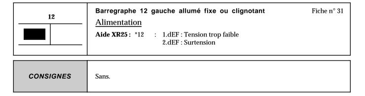
Effectuer les interventions nécessaires pour obtenir une tension +APC correcte d'alimentation du calculateur : 9,5 volts < tension correcte < 18,5 volts.
